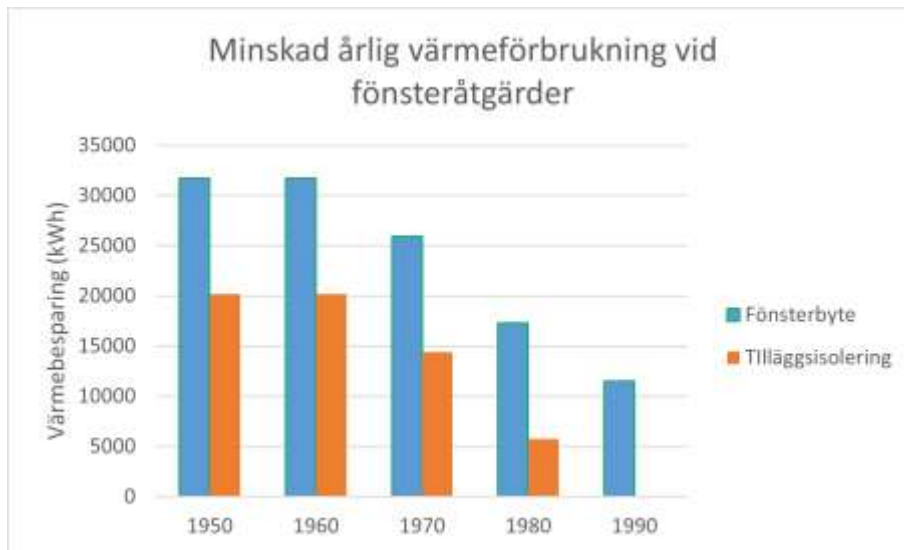
Figur 5: Diagrammet visar hur fönsteråtgärderna beräknas påverka byggnadens årliga värmeförbrukning, beroende på vilket årtionde originalfönstren tillverkades.
