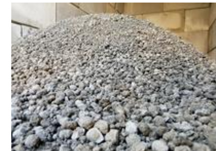
Granulat av betong
