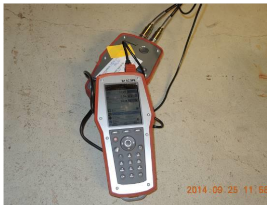
Bild 6. Momentanmätning av VVC-flöde, 2200 l/h och VVC-temperatur, 52,8°C.
