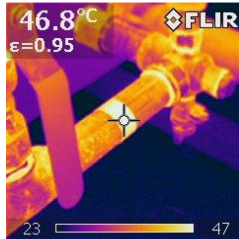
Bild 4 Temperatur på VVC uppmättes momentant till 46,8°C vid besöket.
