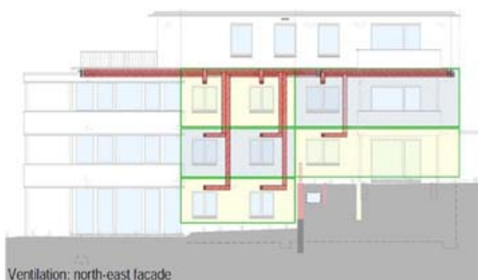
Figur 33. Nord-östra fasaden. Det nya ventilations- systemet är integrerat prefab-elementen. Källa: IEA ECBCS Annex 50.
