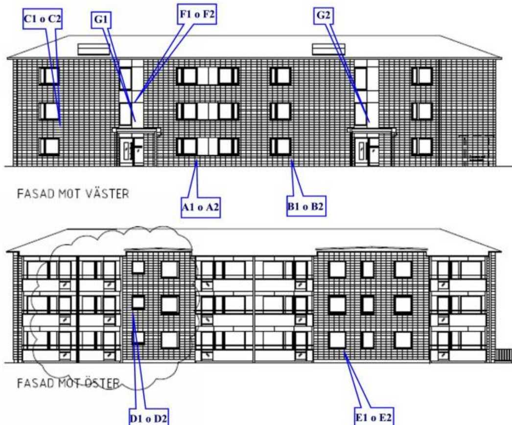
Figur 18 Givarplacering för uppföljningen av fukttillstånd i överst den västra väggen, nedanför den östra. Givarna placeras ut i par, där A-E markerar givare i väggen, F paret med innegivaren och G de två mottagar/sändningsnoderna Bild: Magnus Hansén, SP
