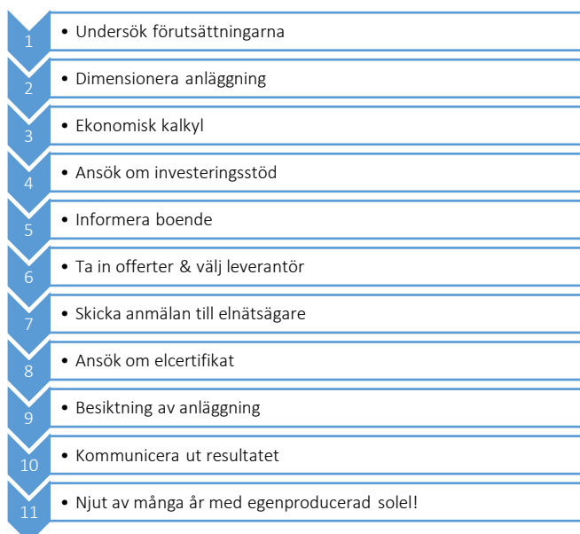
Figur 12: Tidslinje för en solcellsinstallation.
