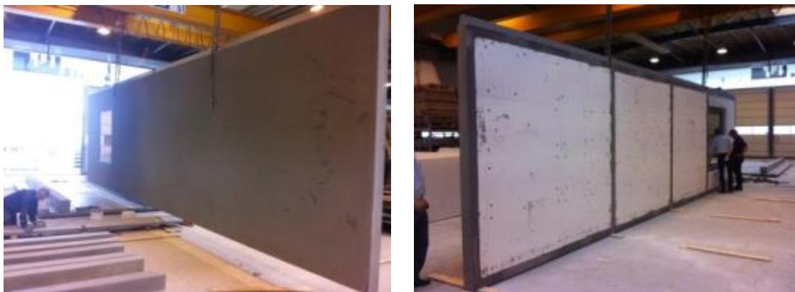
Figur 6. Soleedelementen tillverkas i fabrik. Foto: Soleed.
